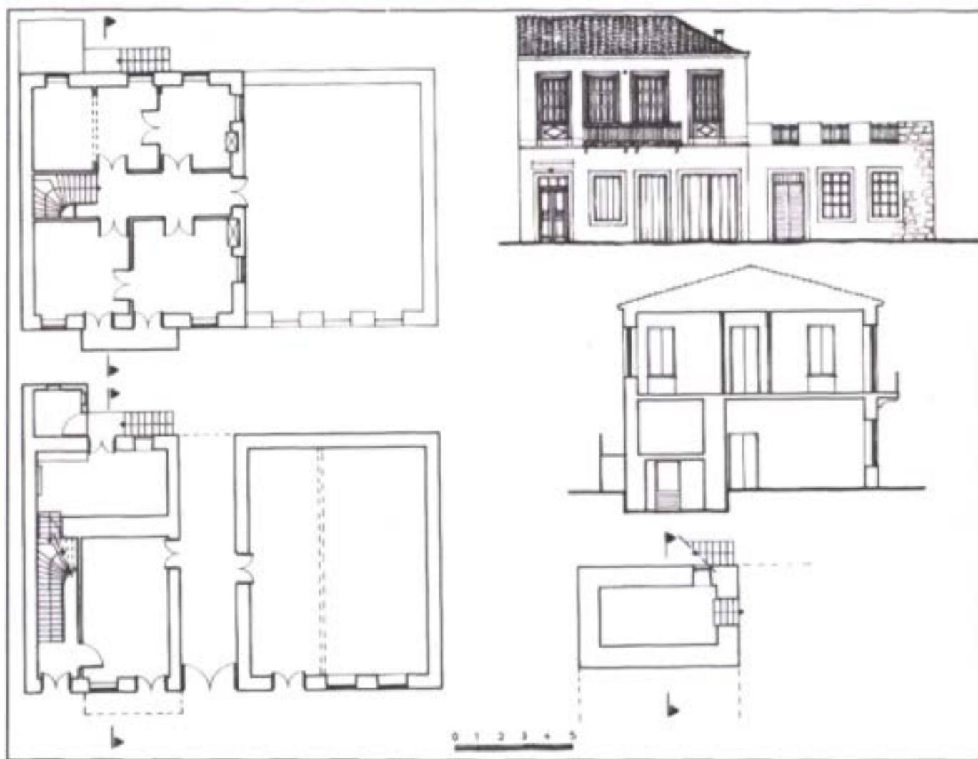
Εικόνα 3.41: Τύπος σπιτιού με αποθήκη μικτής αρχιτεκτονικής στην Ιτέα. Από αριστερά προς τα δεξιά: πάνω, κάτοψη ορόφου, όψη, τομή, κάτω: κάτοψη ισογείου, κάτοψη υπογείου. Πηγή: Κουρεμένος, 1987.
