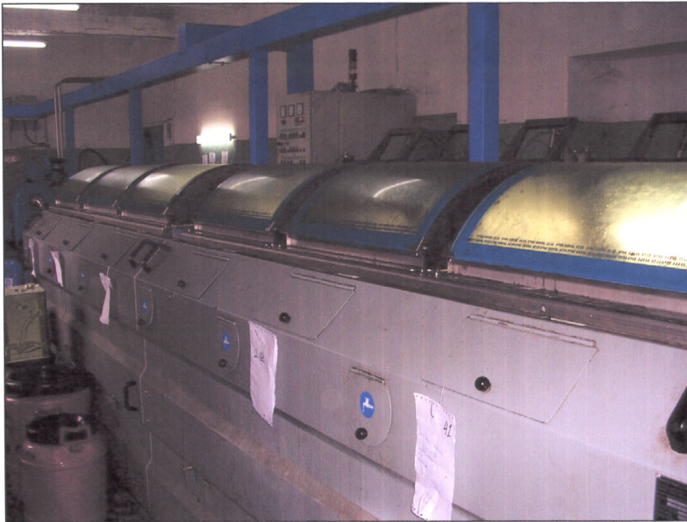
Εικόνα 1.35: Σύγχρονοι μαλακτήρες από το συνεταιριστικό ελαιοτριβείο Ιτέας Πηγή: Αρχείο Π. Αραβαντινού.
