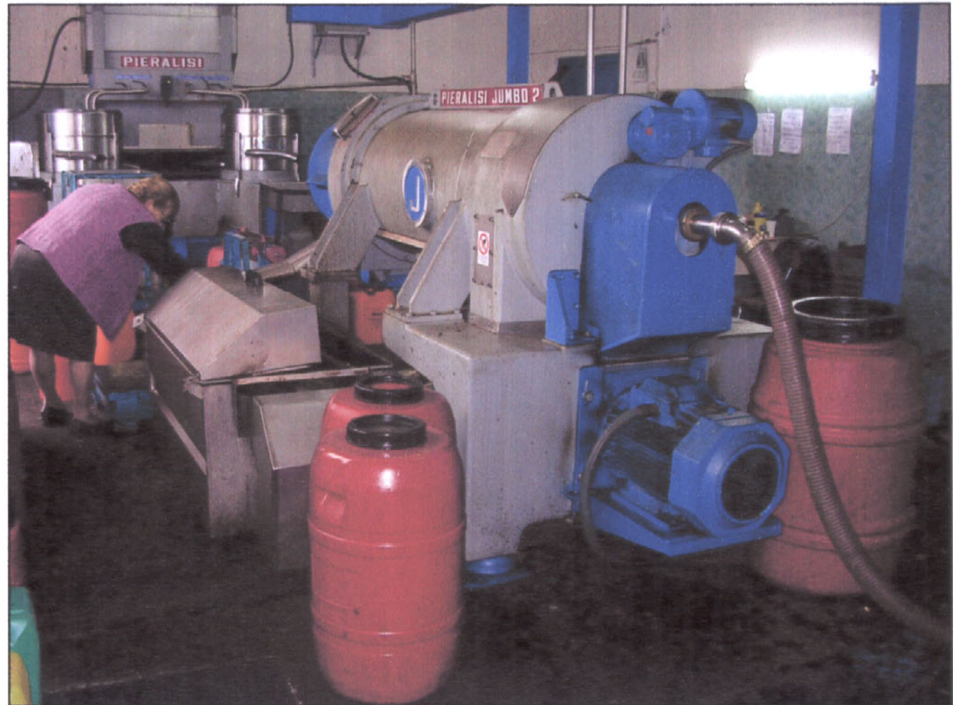
Εικόνα 1.38: Διαχωριστήρες de Laval από το ελαιοτριβείο του Μαρμαρέλη στα Πενταόρια. Πηγή: Αρχείο Π. Αραβαντινού.
