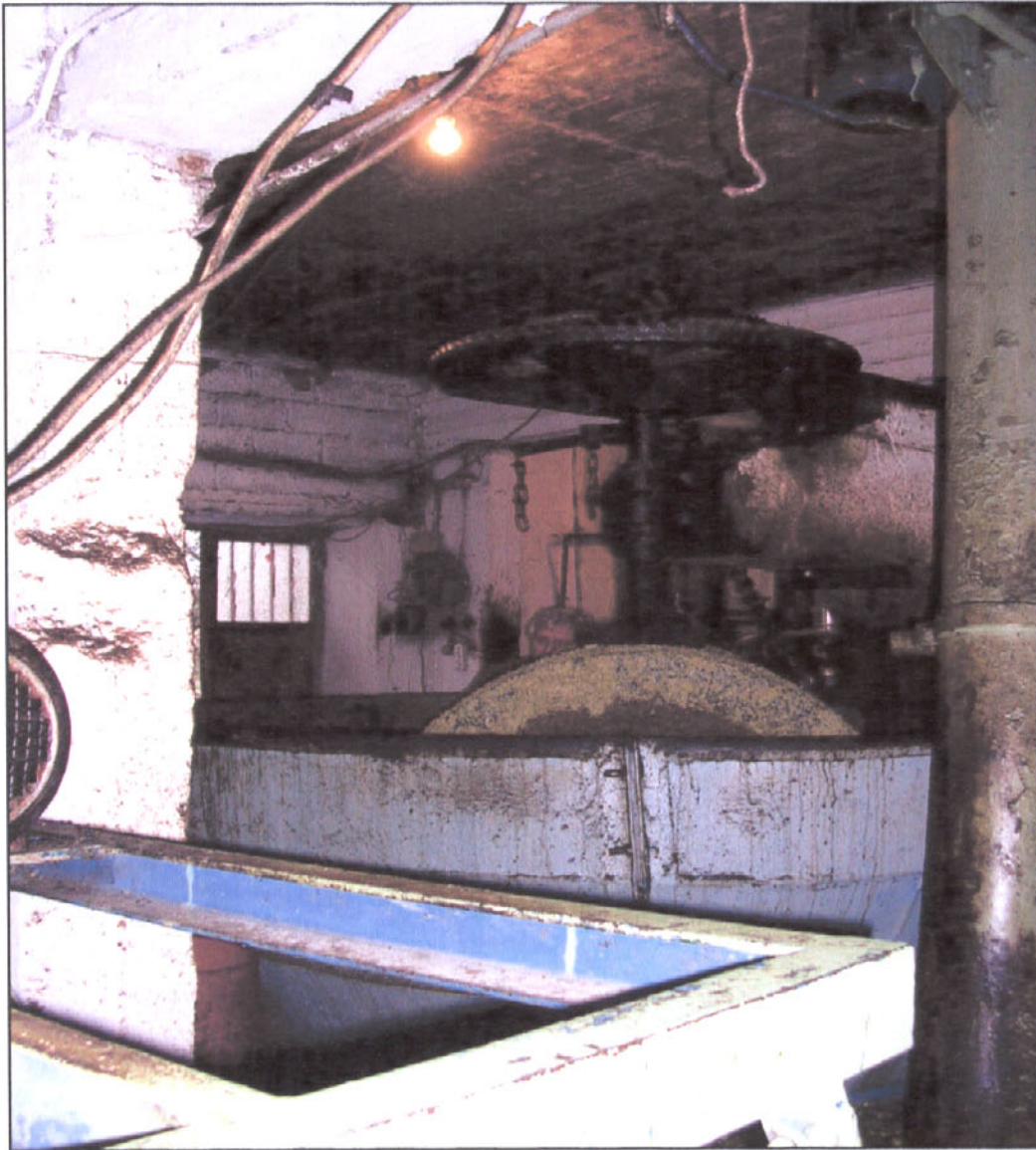
Εικόνα 1.30: Παραδοσιακό θρυπτήριο με μυλόπετρες από το ελαιοτριβείο του Γκανιάτσου στην Άνω Σεργούλα. Πηγή: Αρχείο Π. Αραβαντινού.
