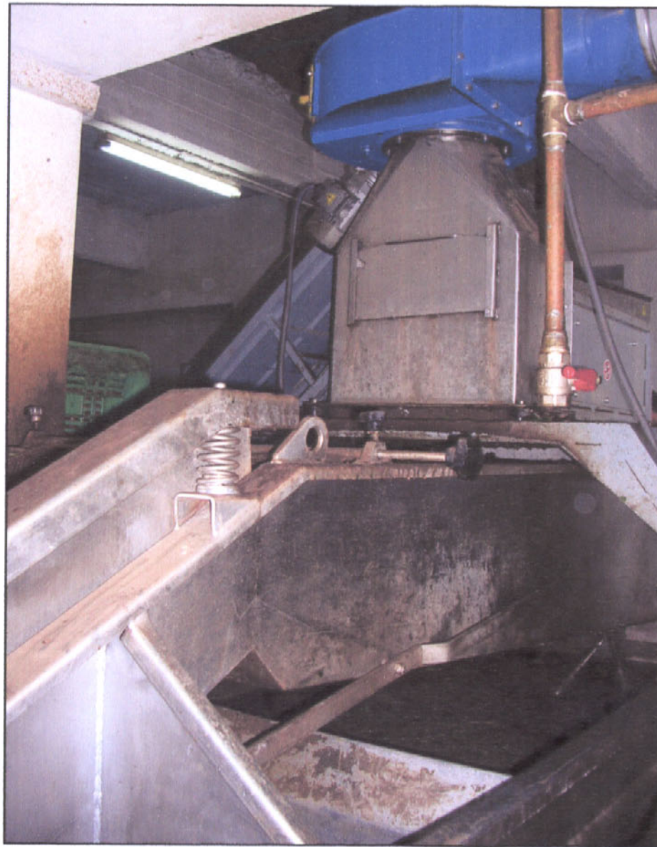
Εικόνα 1.29: Σπαστήρας και στο κάτω μέρος αυτού γίνεται η πλύση της ελιάς, από το Συνεταιριστικό ελαιοτριβείο της Ιτέας. Πηγή: Αρχείο Π. Αραβαντινού.
