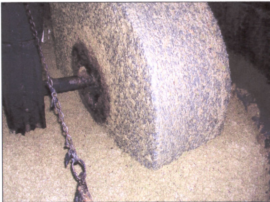
Εικόνα 1.32: Παραδοσιακό θρυπτήριο με μυλόπετρες από το ελαιοτριβείο του Γκανιάτσου στην Άνω Σεργούλα. Πηγή: Αρχείο Π. Αραβαντινού.
