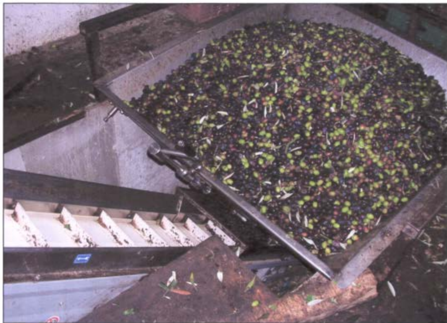
Εικόνα 1.27: Καρύκι με αναβατόριο από το Συνεταιριστικό ελαιοτριβείο της Γτέας. Πηγή: Αρχείο Π. Αραβαντινού.
