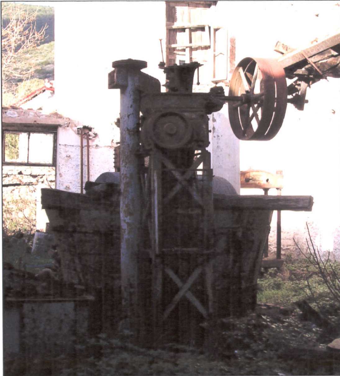
Εικόνα 1.15: Υδραυλικό Αλώνι και μάντας που κινούσε το λίθινο πιεστήριο των Σ. Τραχανά-Π. Αβραμίκου στην Άμφισσα. Πηγή: Αρχείο Π. Αραβαντινού.
