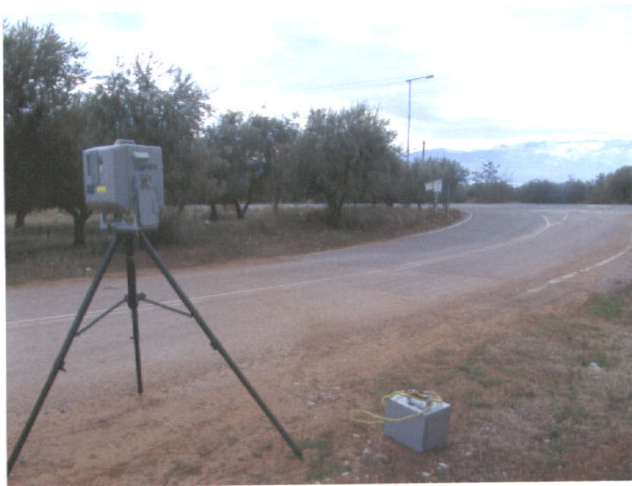
Εικόνα Γ.12 : τρισδιάστατος σαρωτής CYRAX 2500
